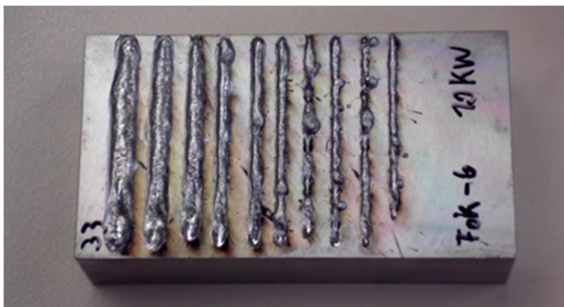
Abb. 2 Nahtberräupen der Blindschweißungen an AlSi12 bei P_L = 10 kW und Fokuslage -6 (Optik F500 Fa. Precitec) mit v_s = 33 \dots 167 mm/s (2 .. 10 m/min)
